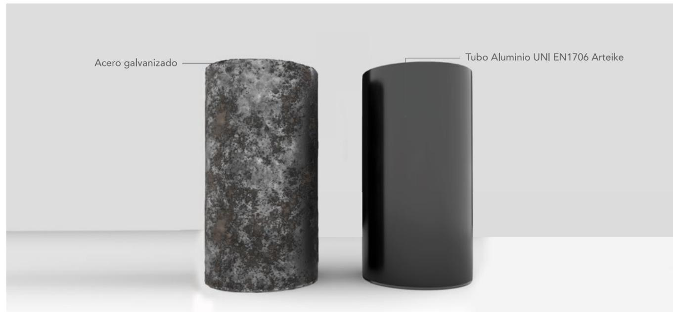
Muestra de acero galvanizado de otro fabricante y Aluminio UNI EN1706 de Arteike, ambos tras 2000 horas de exposición en cámara de niebla salina.
