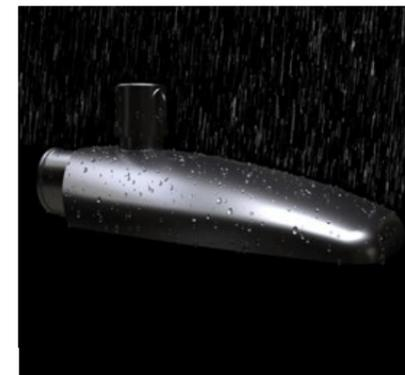
Ensayo Arteike: proyección de agua desde todos los ángulos a un promedio de 100 l/min con una presión de 100 kN/m<sup>2</sup>.
