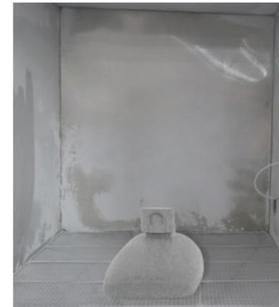
Ensayo Arteike: nube en movimiento continuo de 2 kg/m<sup>3</sup> de polvo de diámetro inferior a 75µm.
