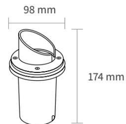
— Los luminarios *uplight* de acabado bronce cuentan con un nivel de resistencia óptimo para empotrarse en pisos y sustratos, además, puede utilizarse como bañador de muro.
