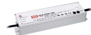
Driver de 240W, 100-277 V salida a 42 VCD, atenuable con protocolo 0-10V e IP67.
