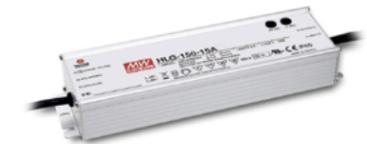
Driver de 150W, 100-277 V salida a 42 VCD, atenuable con protocolo 0-10V e IP67.
